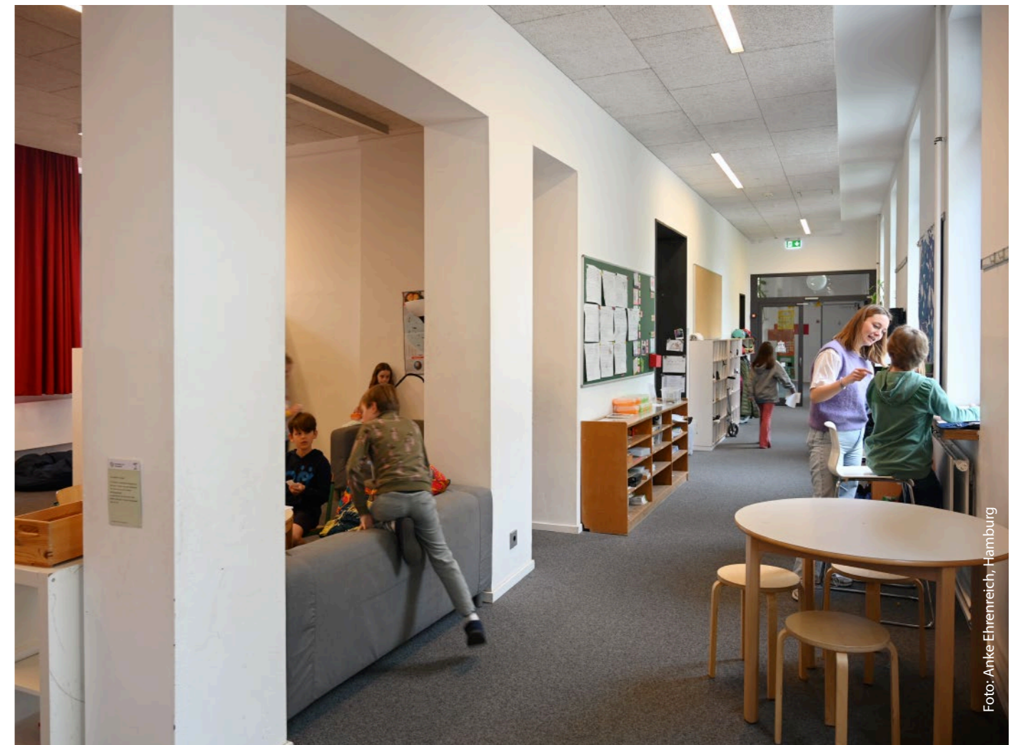
Kompartments im Altbau: Neue Rauchabschlusstüren und zusätzliche Fluchttreppenhäuser erlauben die Nutzung der Flure als pädagogische Arbeitsflächen.
