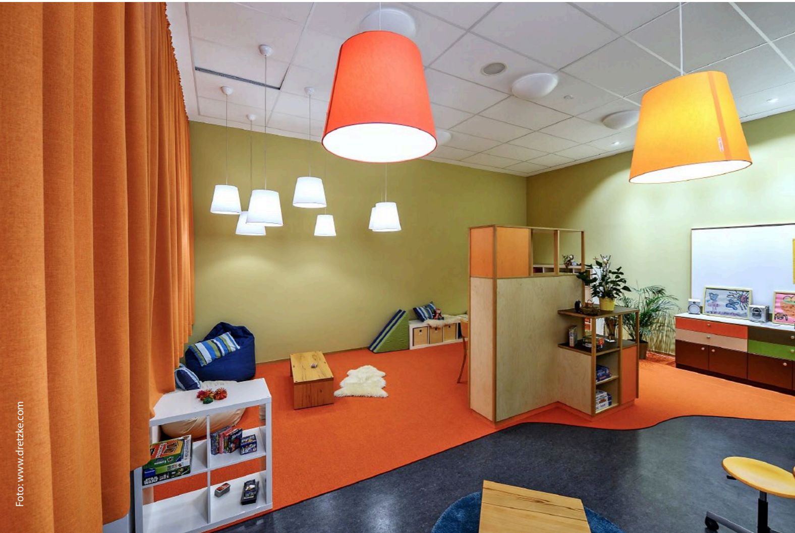
Ein Akustik-optimiertes Klassenzimmer ist nicht nur für Menschen mit Hörbeeinträchtigungen nützlich, sondern dämpft allgemein die Lautstärke, beruhigt alle anwesenden Personen und schont wirkungsvoll die Gesundheit. Wirksame Maßnahmen sind Teppichböden, Stoffgardinen, Schall- absorbierende Deckenplatten und Schallabsorber an den Wänden, z. B. Schall- absorbierende Pinnwände. Bildungshaus Thadenstraße, Hamburg.
